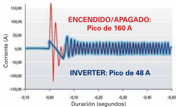
Corriente de entrada reducida
